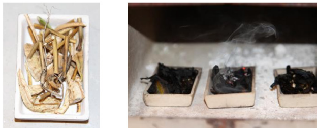
Рисунок 5 – Результаты сжигания бобовых в муфельной печи
