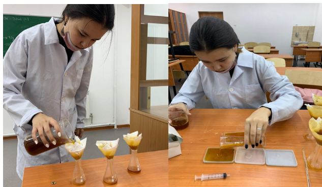
Сурет 2 – NaOH ерітіндісіндегі еріген жүн ерітіндісін фильтрлеу және биопластик жасау барысы.
